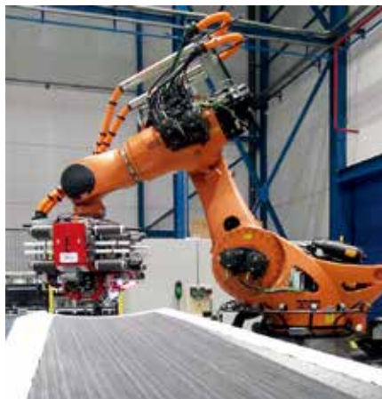
AFP 用于铺设翼盒蒙皮以及弦杆、撑杆和撑杆加劲件的二维坯料。
