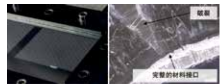
图 2：金属表面处理激光成型工艺（左）和经 4PB 测试的 FML 试样横截面
