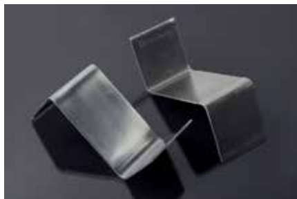
图 1：由亚麻增强聚乳酸芯材和铝表层制成的热成型 Bio-FML
