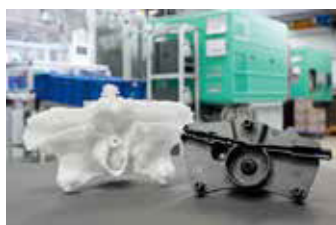
图 5: 博泽电缆驱动器外壳组件 (右) 和显示玻璃纤维的脱落部分 (左)。
