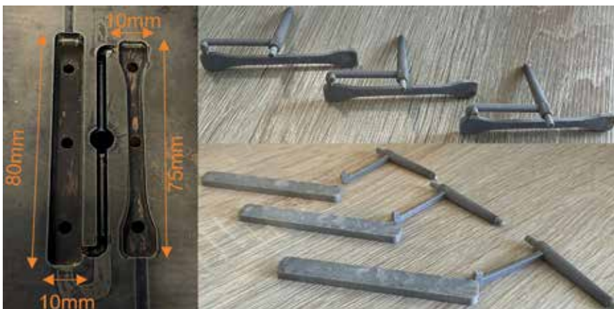
图 4：用不连续玻璃纤维（49%）增强的 2mm 厚狗骨形 / 4mm 厚板 PES/PC 部件及其注塑模具
