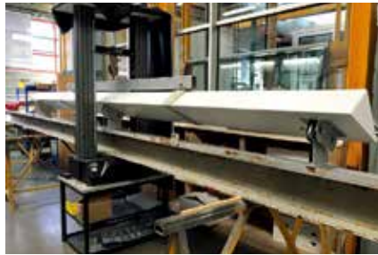
图 4：泡沫 - 玻璃 - 环氧树脂带的疲劳测试
