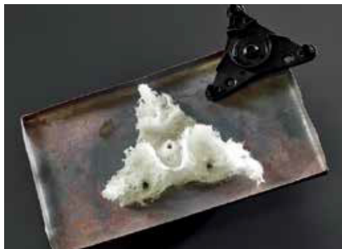
图 1: 电缆驱动器外壳部件（右上）和显示玻璃纤维的灰化部分（左）。灰化试验证明，在 FDC 过程中，纤维均匀地分布在组件中。
