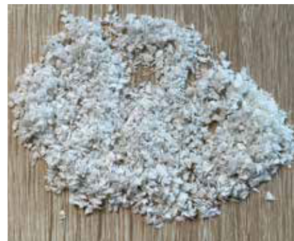
图 2：热塑性内墙板的地面混合材料
