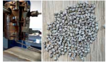
图 3：挤压研磨混合物（左）和挤压出的颗粒（右）
