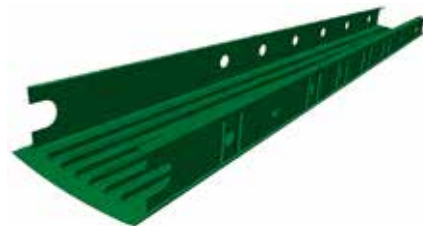
利用真空树脂灌注技术，为 C-295 涡轮螺旋桨验证机的左右机翼制作 4 米长的无紧固件外扭矩盒 3D 仿真。
